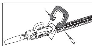
Posizionare la maniglia di guida sull'attrezzo e fissarla con le due viti imperdibili già incorporate.
